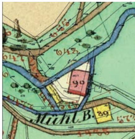
*Im Urmappen- Auszug vom Vermessungsamt Tirol sieht man den Mühlbach, der südlich und dann östlich der Mühle (übers Rad) vorbeiführt und wieder zum Bach geleitet wird. Für die Säge wird davor das Wasser abgeleitet, um diese (in Gelb eingezeichnet) mit Energie zu versorgen.*
