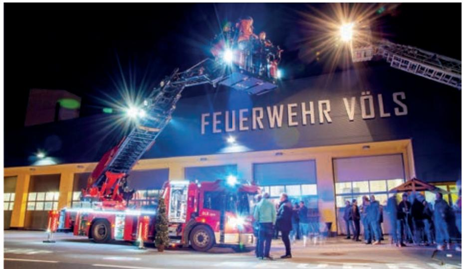
Fahrzeug mit 3 Atemschutzgeräten und einem Akku Belüftungsgerät ausgestattet. Durch das Gelenkteil am Leiterpark ist es möglich auch in engen Gassen den Korb vor der Fahrerkabine abzulegen. Ein top modernes Gerät, das von der Marktgemeinde Völs und dem Land Tirol finanziert wurde.
